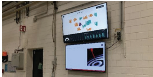
Abb. 1 Informationen zur Maschinenverfügbarkeit, die den Mitarbeitern in der Fertigung zur Verfügung gestellt werden, um die Transparenz zu erhöhen und eine kontinuierliche Verbesserung zu erreichen.
